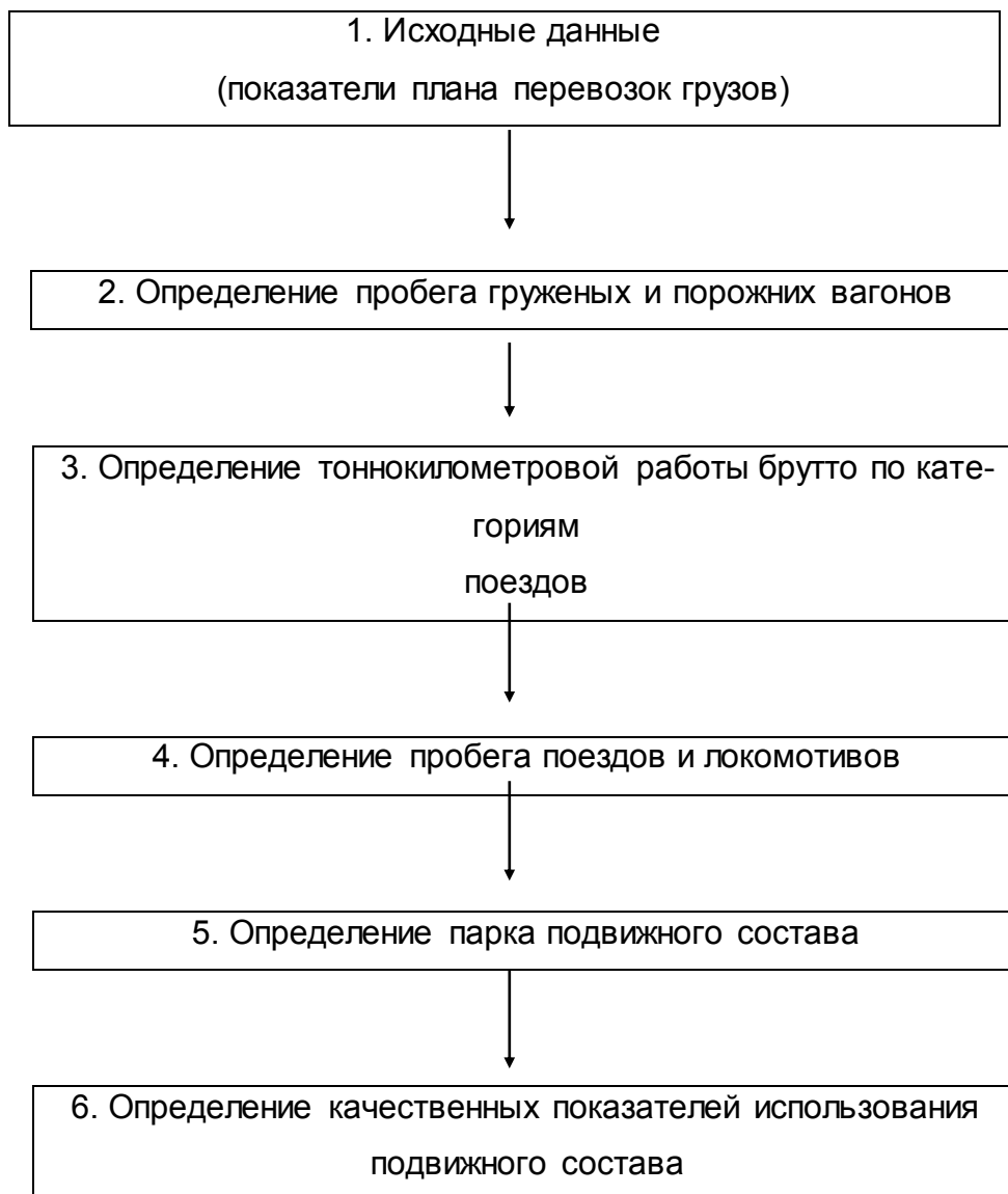
Рис 2.1. Схема расчета показателей плана работы подвижного состава
