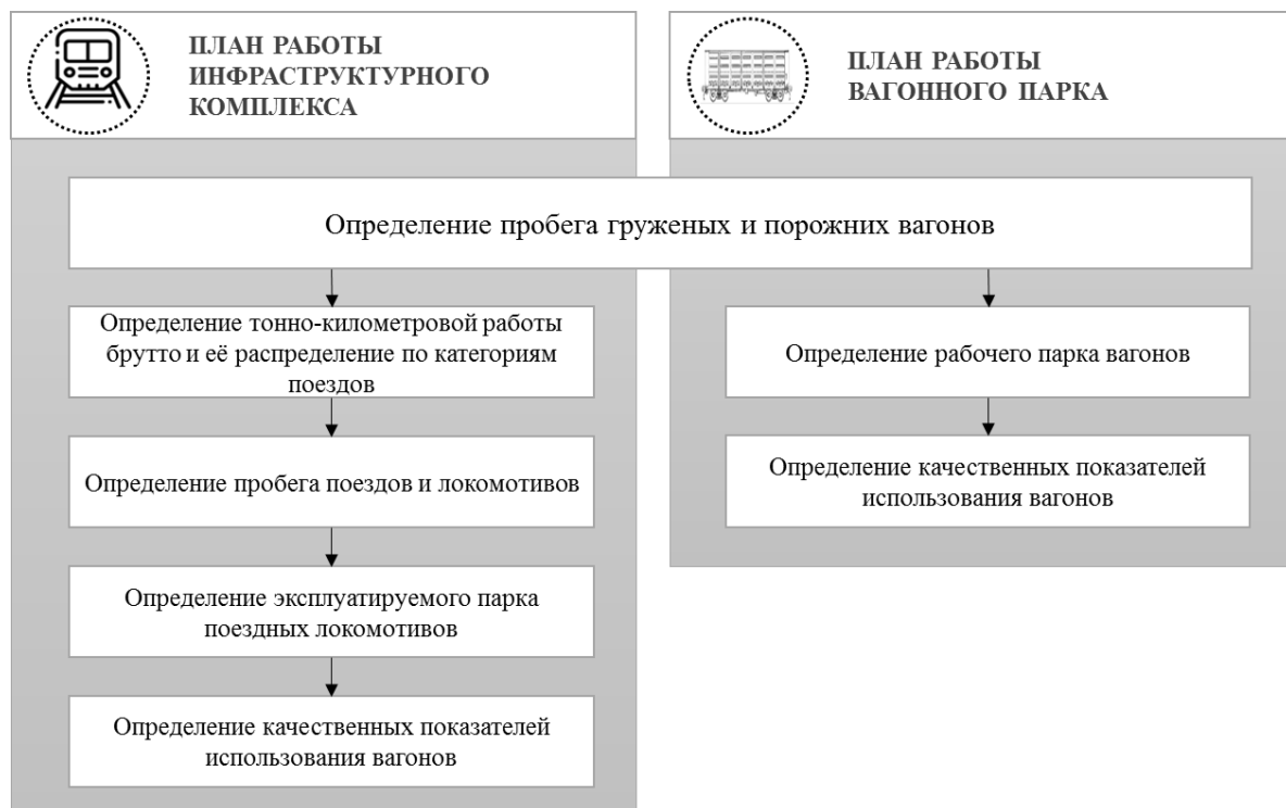
Рисунок 3.1 – Схема расчета показателей плана работы подвижного состава.
