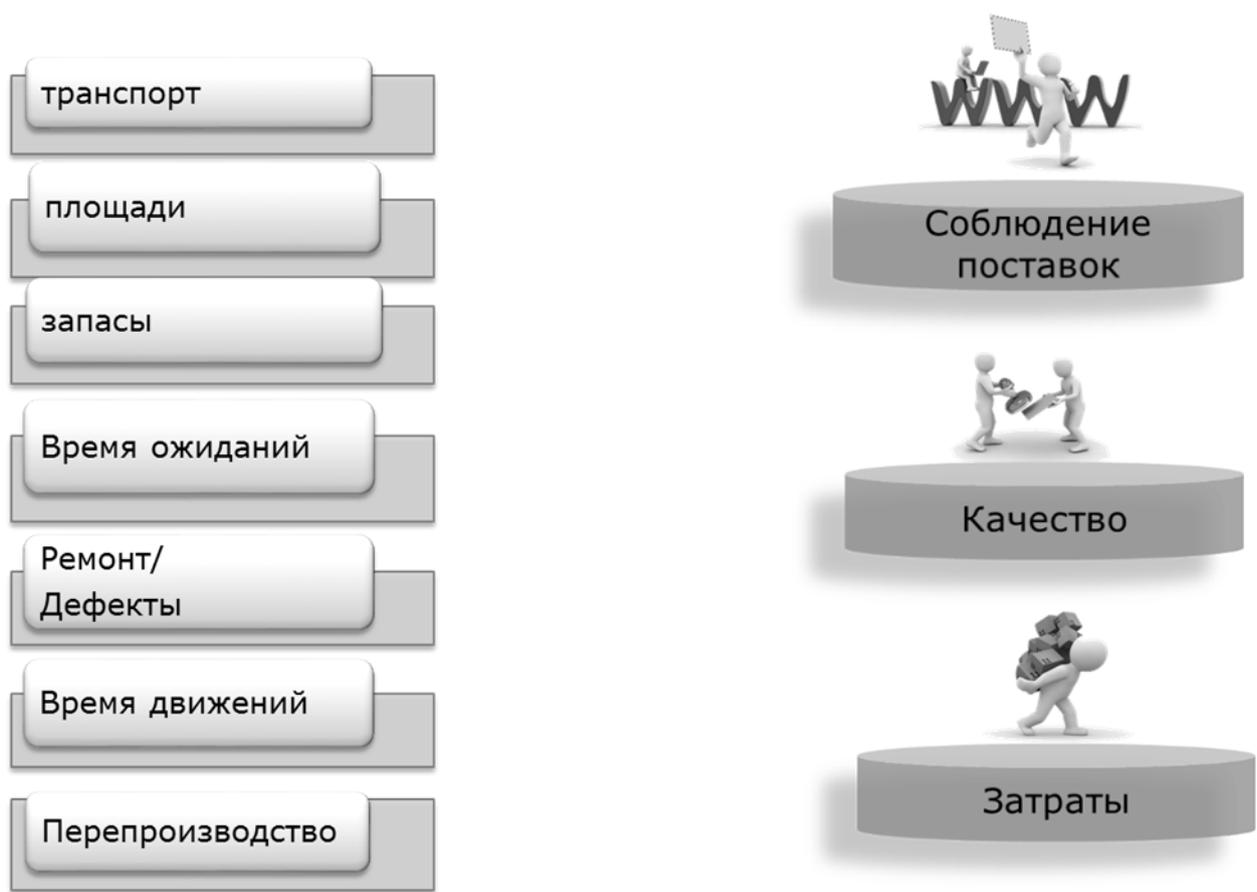
**Рис. 6.6. Семь видов потерь в процессе производства**
