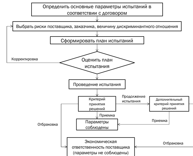
Рис. 5.7. Алгоритм верификации показателей надежности технических систем
