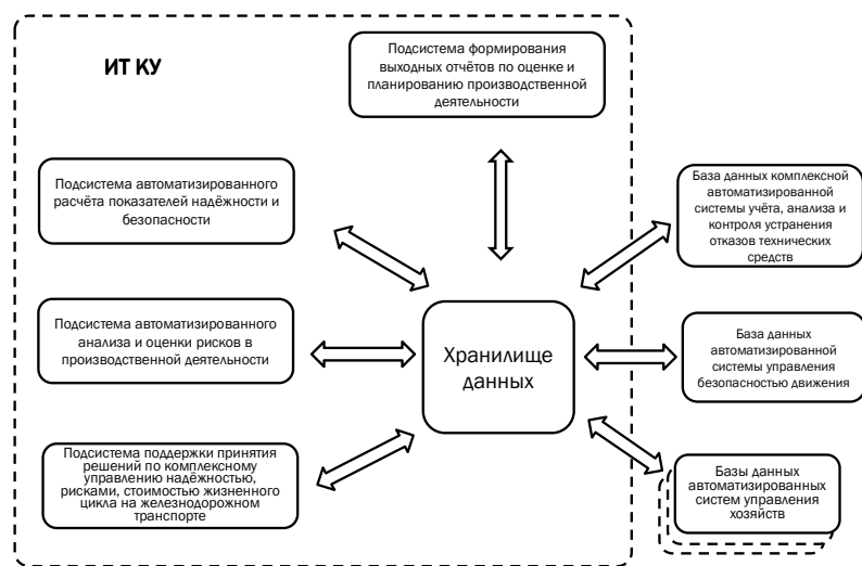
Рис. 6.7. Структура и компоненты информационной технологии комплексного управления надежностью, рисками, стоимостью жизненного цикла
