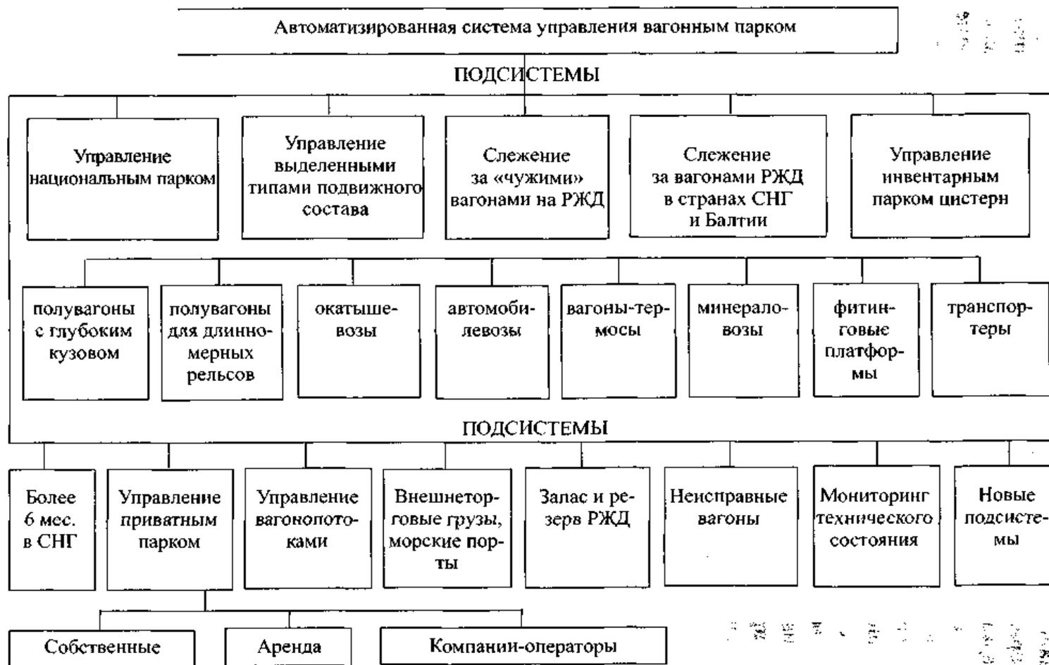
Рис. 3.1. Функциональная структура автоматизированной системы управления вагонным парком
