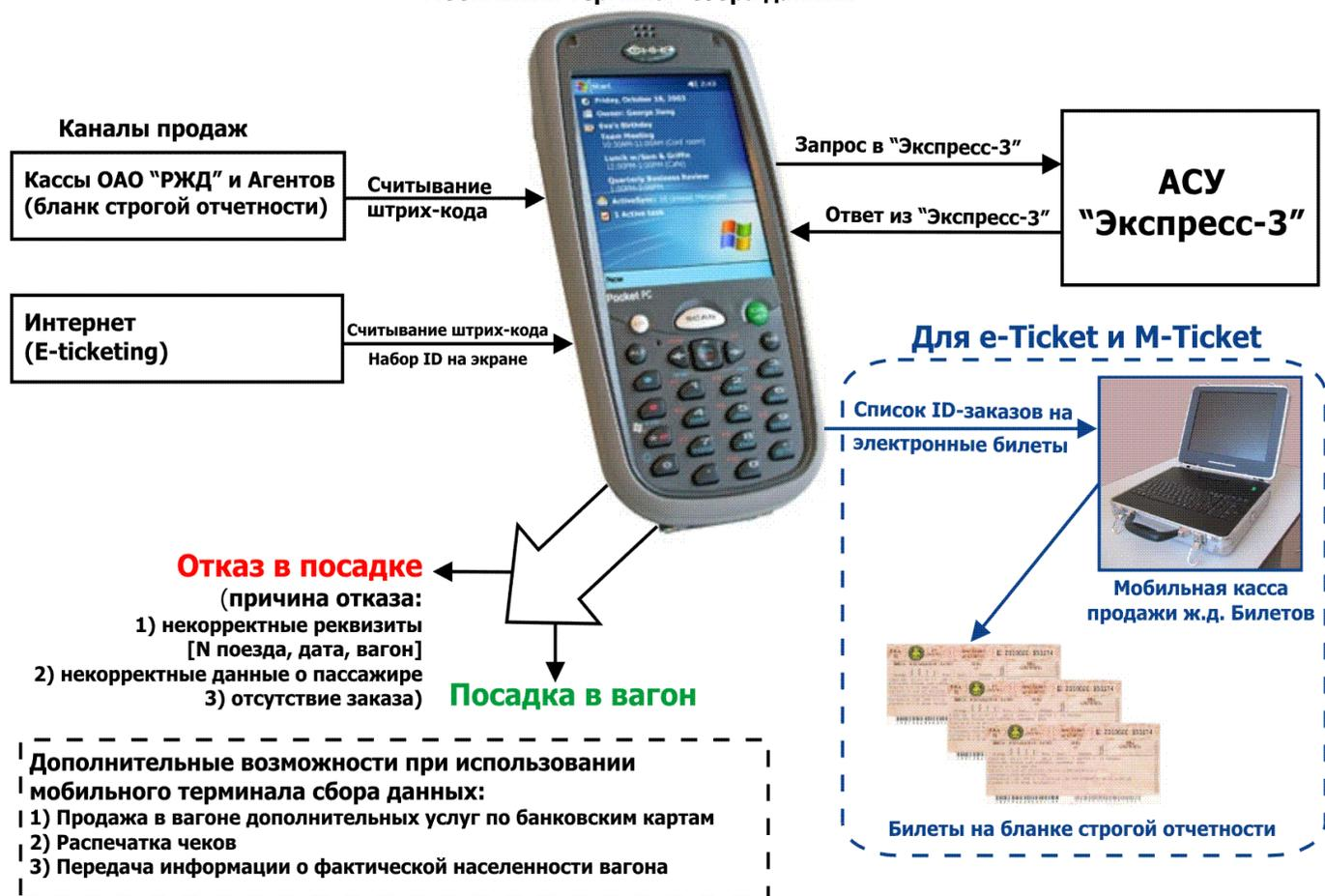
Рис. 3.13. Схема доступа пассажира в вагон с использованием МТСД
