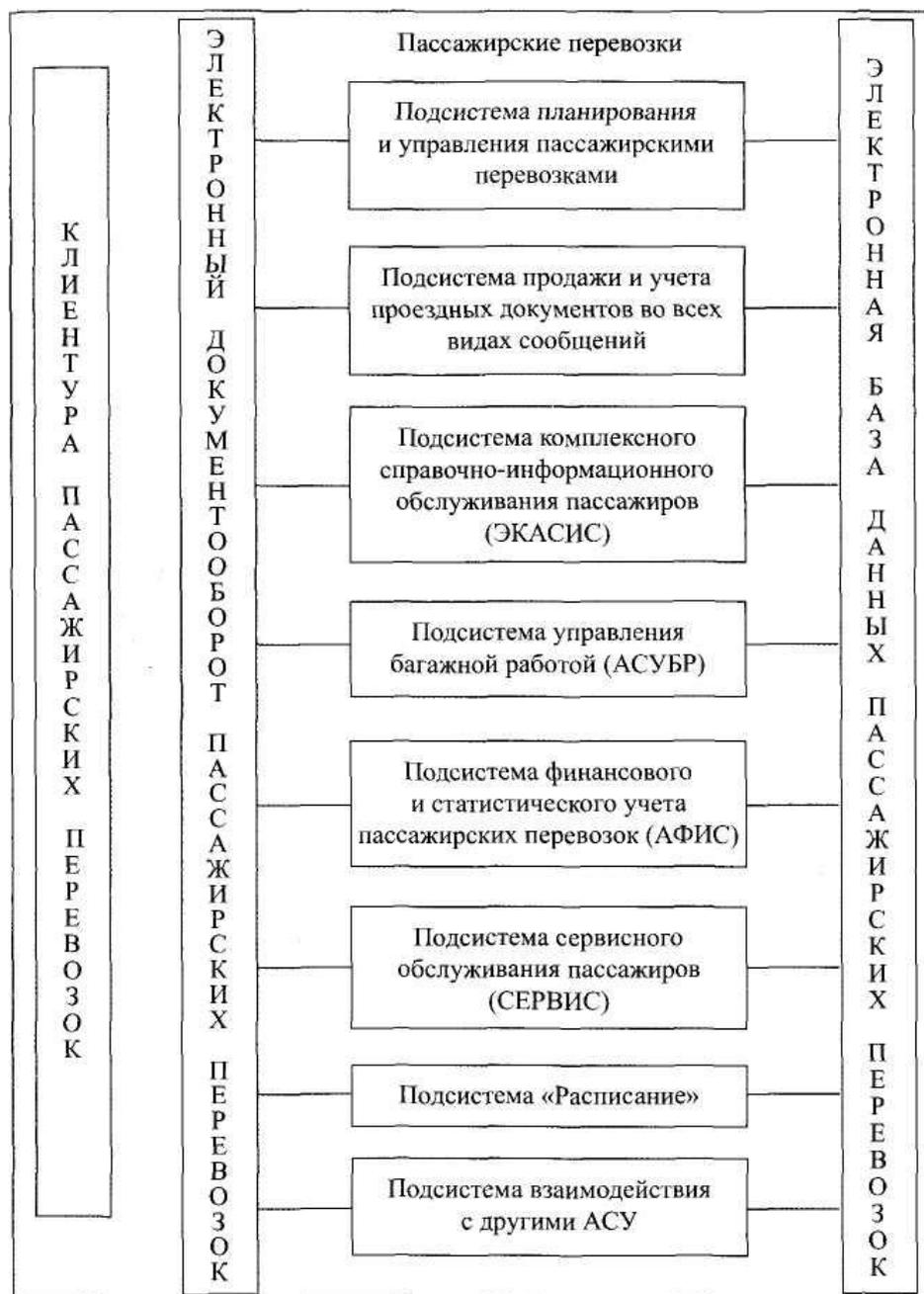
**Рис. 3.12. Функциональная схема АСУ «Экспресс-3»**
